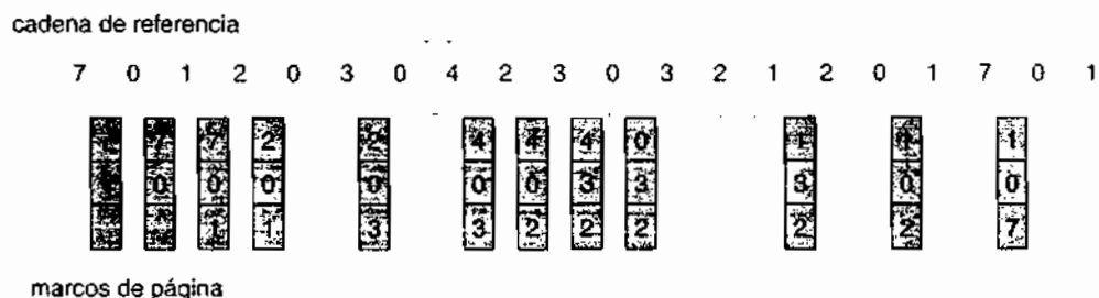
Figura 9.15 Algoritmo LRU de sustitución de páginas.
