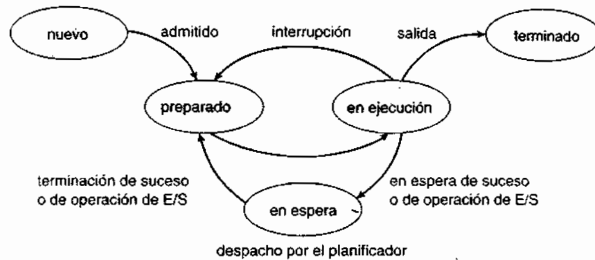
Figura 3.2 Diagrama de estados de un proceso.
